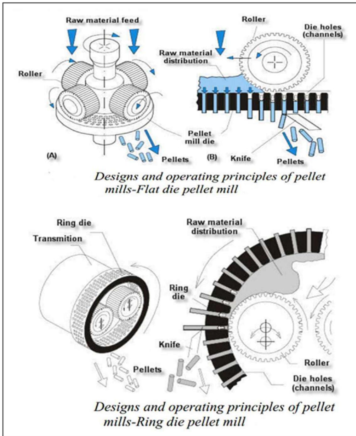
Figure 22. Wood pellet press machine
